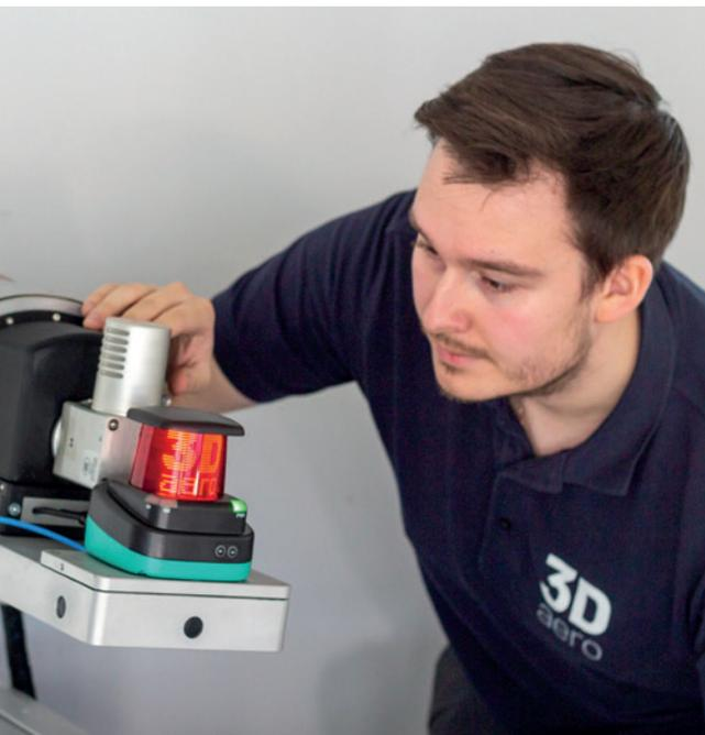
3D. SwivelScan - Die Innovation in der Scantechnologie. Basierend auf der neusten 3D Sensortechnologie liefert das System kalibrierte, farbige 3D-Punktwolken-Informationen.
